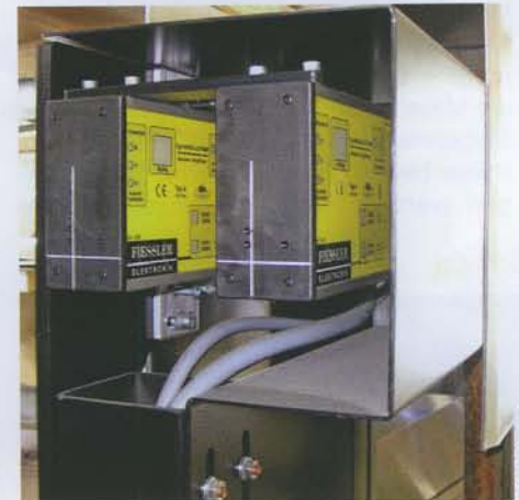
Empfänger des dreidimensionalen Laserschutzfeldes. Damit müssen keinerlei Kompromisse bezüglich der Sicherheit an einer Schwenkbiegemaschine eingegangen werden.
