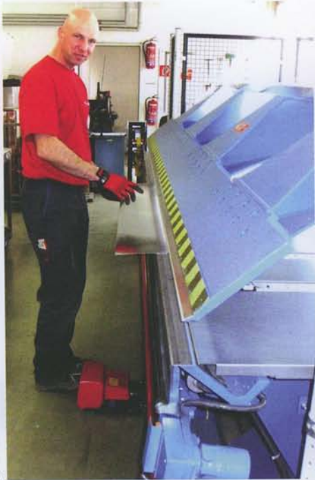
Einlegen des Blechwerkstückes in die Jorns-Schwenkbiegemaschine a und Kanten des Werkstückes b.
