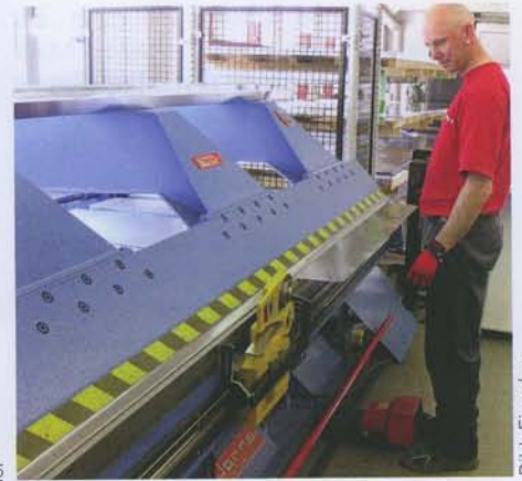
Eine Schneideinrichtung an der Schwenkbiegemaschine bringt das Werkstück auf die richtige Länge.
