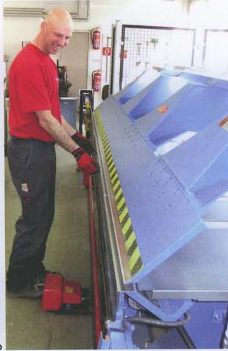
Einlegen des Blechwerkstückes in die Jorns-Schwenkbiegemaschine a und Kanten des Werkstückes b.
