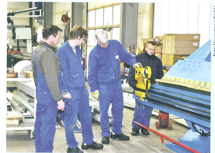
Die Mitarbeiter der Firma Hausemann begutachten das zum Patent angemeldete zusätzliche Sicherheitssystem der beweglichen Rollenschiene. Bei 10 kg Druck klinkt sich die Schere automatisch aus der Seilführung.
