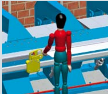
Gefahr: Quetschen und Schneiden durch automatisch bewegendes Scherensystem
