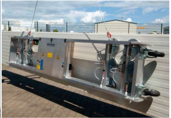
Die Bauelemente können sowohl horizontal als auch vertikal transportiert werden.
