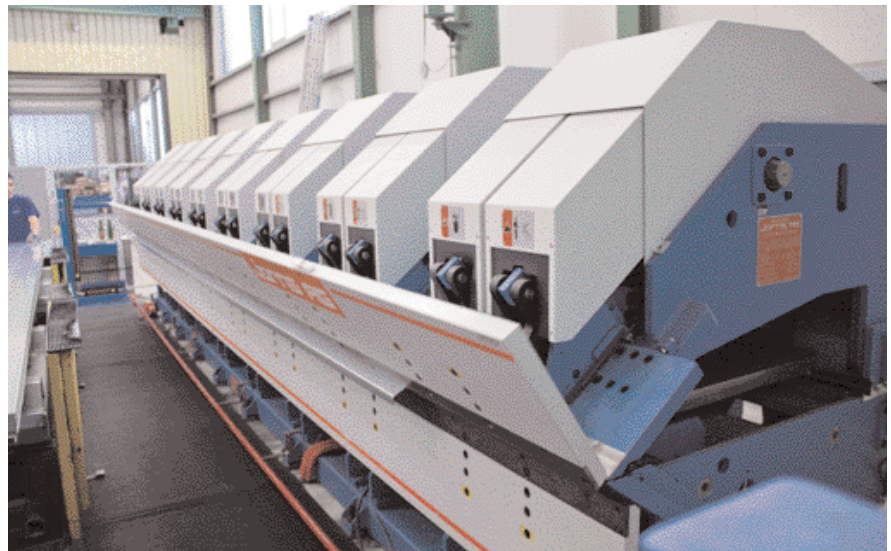
Die Jorns-Doppelkantmaschine in voller Aktion: Bis zu 98 Kantungen an einem Blech sind möglich
