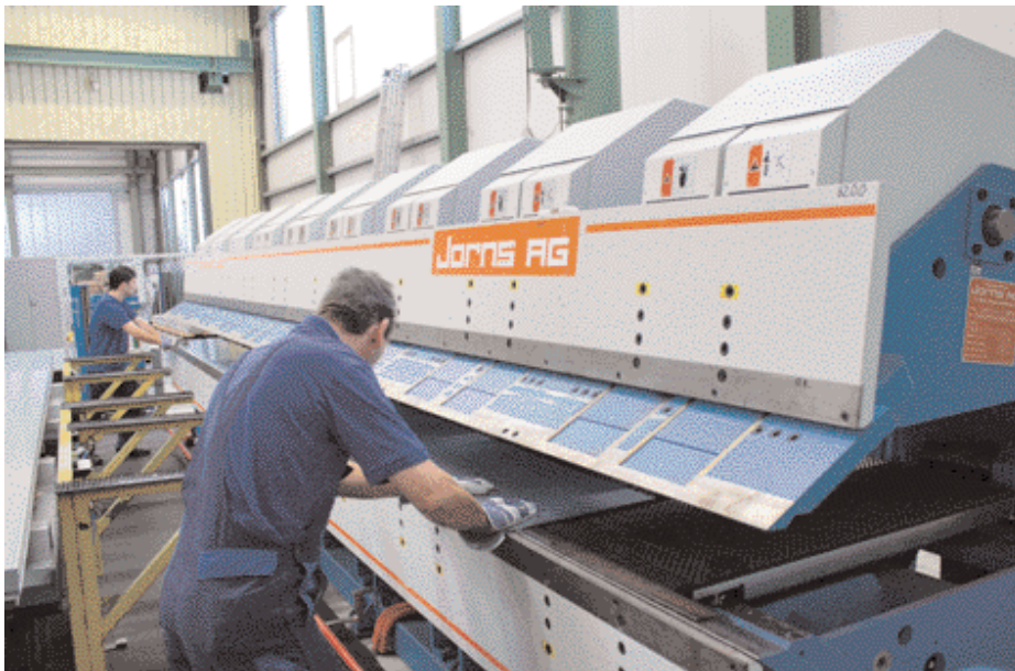
Die Maschinenbediener müssen das Blech lediglich über die Zuführarme in die Anlage schieben und das fertige Teil entnehmen
