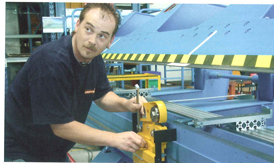
Montageleiter Bruno Blaser bringt eine neue Rollenschere in Position ...
