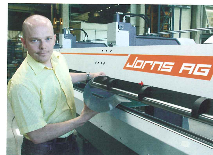
Reto Staeger führt die neue Jorns-Rinnenmaschine RM 150 vor. Auf der mit drei synchron angetriebenen Walzen ausgestatteten Anlage können zahlreiche gebogene Profilformen hergestellt werden
