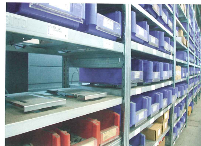
Selbstüberwachende Bestandskontrolle: Unter jedem Lagerbehälter befindet sich eine Waage, die via Internet sofort meldet, wenn festgelegte Gewichtsbereiche unterschritten werden
