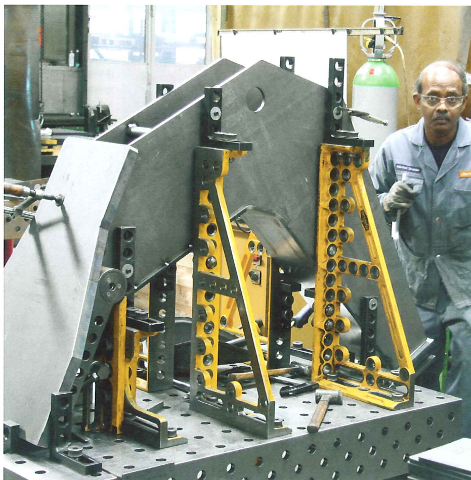
Bei Jorns werden die Einzelteile der Maschinenständer von hoch spezialisierten Schweißern sowie von Schweißrobotern zusammengefügt
